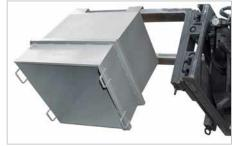
UC-Entleerung mit Stapler-Drehgerät
