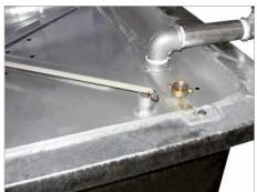
Peilstab zur Füllstandskontrolle
