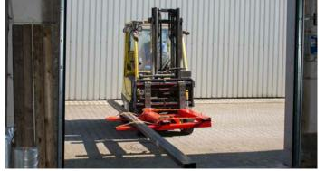
$Einfaches\ Passieren\ durch\ Tore\ und\ G\"{a}nge\ beim\ Transport\ von\ Langgut material\ mit\ dem\ LSL$
