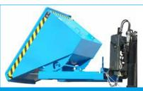
Kippbehälter mit Abrollmechanismus für staplerschonende Entleerung sowie automatisches Zurückschwenken der Behältermulde in die Ausgangsposition. Durch den günstigen Lastschwerpunkt ist eine volle Ausnutzung der Staplertragfähigkeit möglich und wird mittels Zugseilentriegelung auch in großer Höhe entleert.
