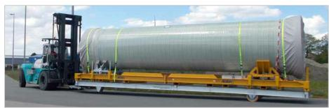
Für den Transport von extrem schweren und sperrigen Teilen: Länge 12 m, Tragfähigkeit 20 t
