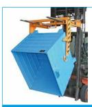
Diese Behälter haben keinen integrierten Kippmechanismus und sind somit eine preiswerte Alternative. Unabhängig von der eingesetzten Behälterstückzahl ist bei identischer Breite der Behälter nur eine Entleertraverse für den Kippvorgang erforderlich. Für die Behälter ohne Aufnahmezapfen wird ein vorhandenes Drehgerät am Gabelstapler sowie durchgehende Einfahrtaschen am Behälter zur Entleerung vorausgesetzt.
