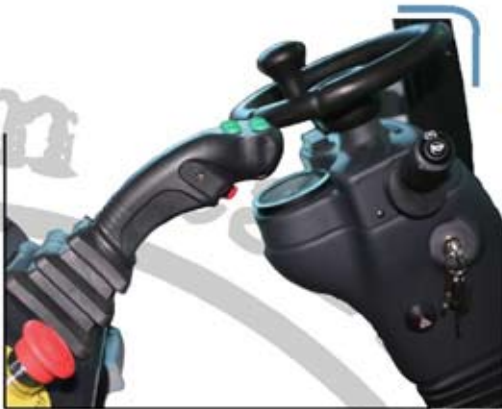
JOYSTICK MIT 5 FUNKTIONEN
